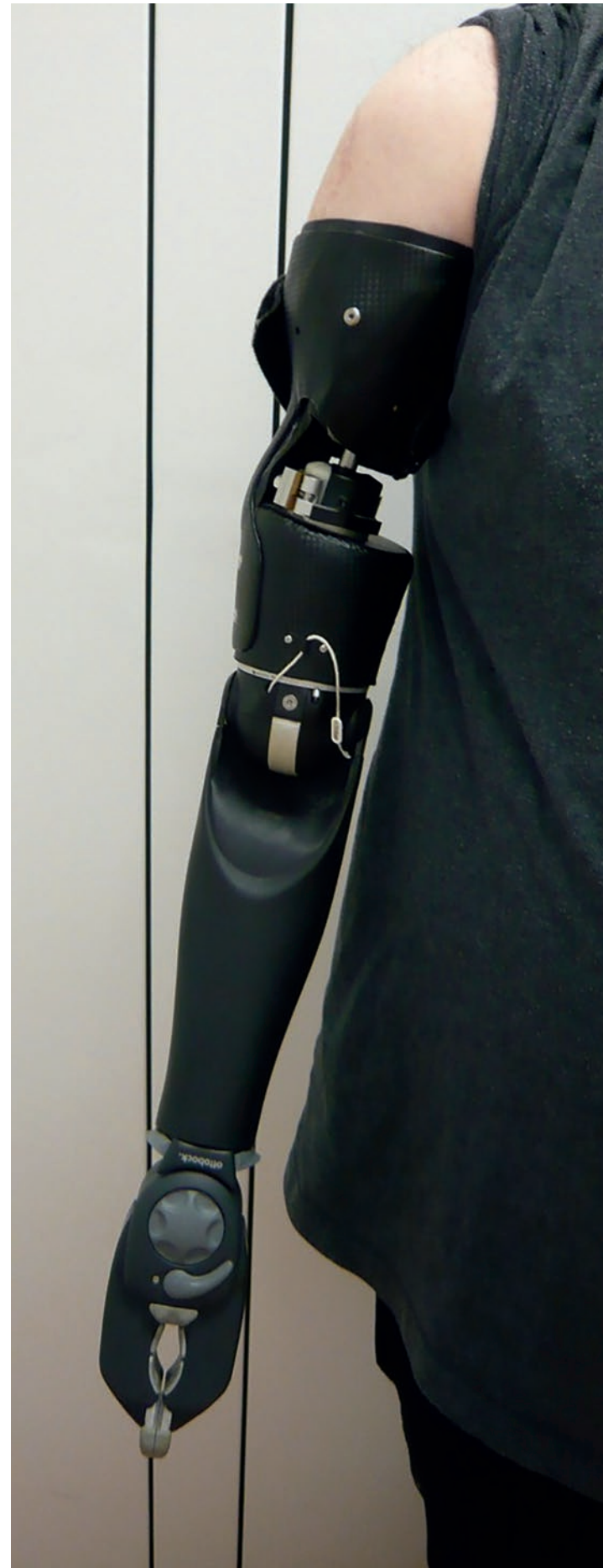
Patient mit TMR und Osseointegration mit myoelektrischer Prothese mit Greifer
